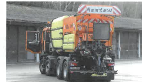
Die Räum- und Streufahrzeuge der Autobahnmeisterei sind mit Feuchtsalzgeräten ausgestattet. Daneben wird bei vorbeugenden Streueinsätzen Sole ausgebracht.
