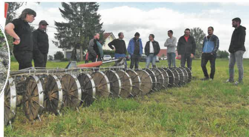
Die Düsen müssen sehr robust sein, um die Depots im Boden anzulegen.
