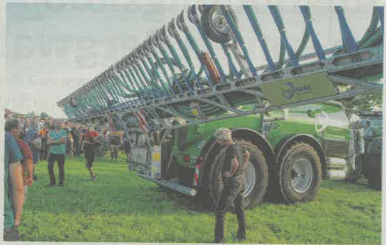
Die Kumm-Technik ist der Hersteller dieses Pump-Fasses, hier mit dem Bomech-Schleppschuhverteiler mit 15 m Arbeitsbreite.
